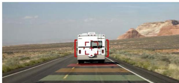
Il sistema calcola in tempo reale la distanza dal veicolo che ci precede mentre si viaggia ad una velocità superiore a 30 km / h in autostrada o meno di 30 km / h in città, rilascia un avviso sonoro a 3 livelli a seconda del pericolo di collisione.
