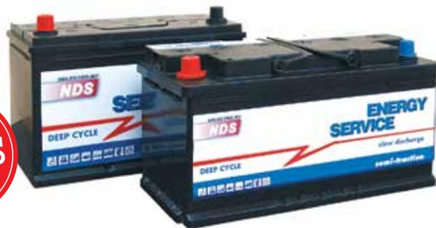
Le **ENERGYSERVICE** sono batterie semi-trazione specifiche per i servizi, costruite con piastre più spesse a geometria radiale e separatori in gomma microporosa accoppiati con lana di vetro, che garantiscono alte performance.
