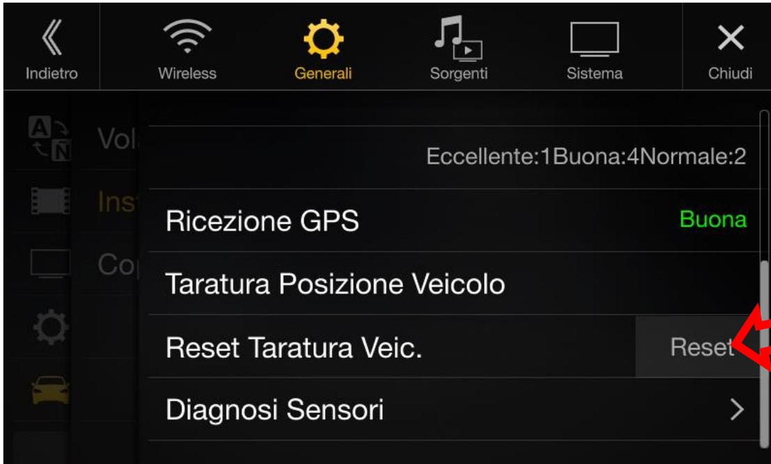
Trovata la posizione ottimale di ricezione e fissata l'antenna GPS si potrà effettuare il Reset Taratura Veicolo.
